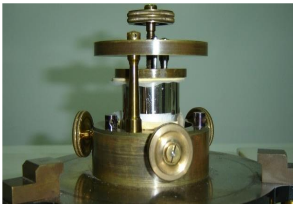
Fig. 8b: Kilogramul Prototip Național fixat în dispozitivul de transport
