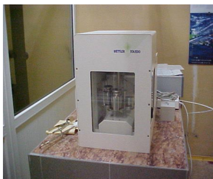
Fig. 14: Comparator automat de masă de 1 kg Fig. 15: Sistem de monitorizare condiții de mediu
