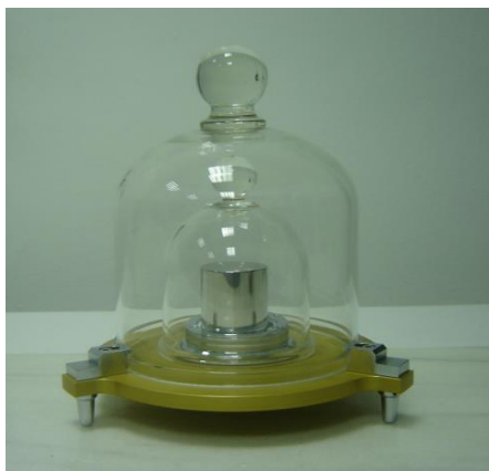
Fig. 8a: Kilogramul Prototip Național Nr.2
