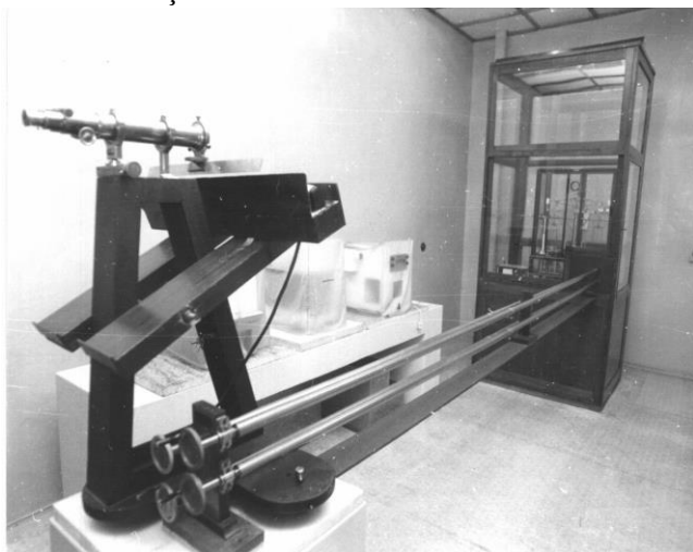
Fig. 11a: Balanța cu manevrare și citire de la distanță (ansamblu)
