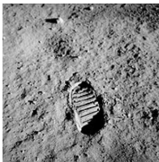
Fig. nr. 9. Urma pasului lui Aldrin. Test al revenirii deformării solului lunar.
