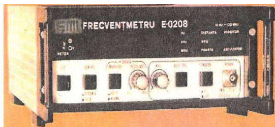
Fig. II.4 Frecvențmetru programabil E 0208
